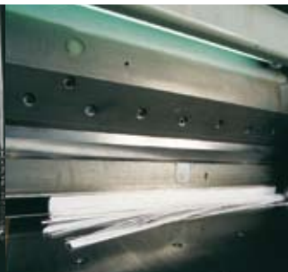
造纸页中切纸刀片的耐磨
